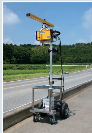
歩道に設置して縁石直下からの計測
